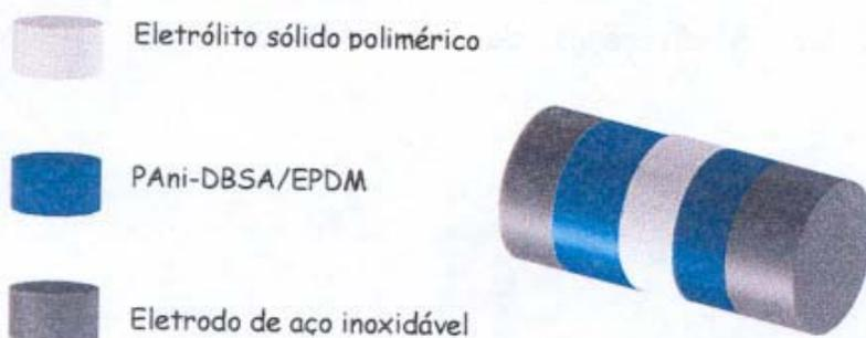
Figura 6.1- Esquema tridimensional do capacitor eletroquímico
