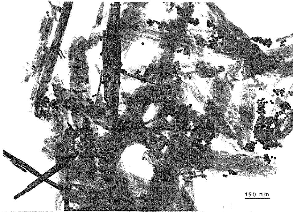
Figura 3-9. Micrografia eletrônica de transmissão de ouro coloidal homocoagulado junto às partículas de goethita, [\text{NaNO}_3] = 0,1 \text{ M} , \text{pH} = 5,6 .
