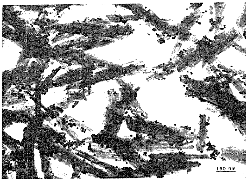
Figura 3-14. Micrografia eletrônica de transmissão do sistema ouro coloidal-goethita previamente heterocoagulado, após adição de [\text{NaNO}_3]_f = 0,1 \text{ M} e ultrassonificação.
