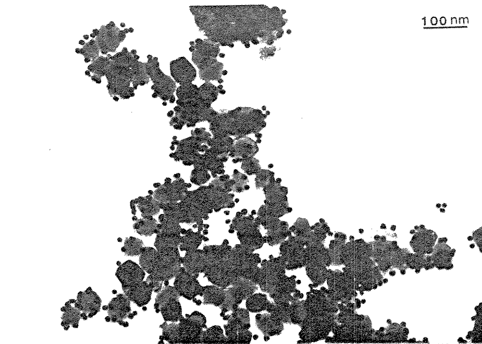
Figura 3-B. Micrografia eletrônica de transmissão de ouro coloidal heterocoagulado com partículas de hematita, [\text{NaNO}_3] = 0,01 \text{ M} , \text{pH} = 6,2 .
