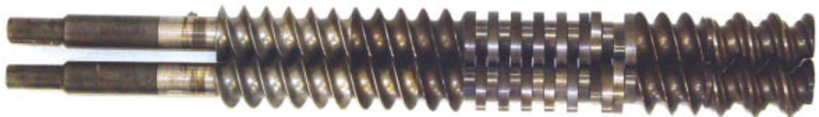
Figura 16: Configuração de rosca utilizada na extrusora APV-30
