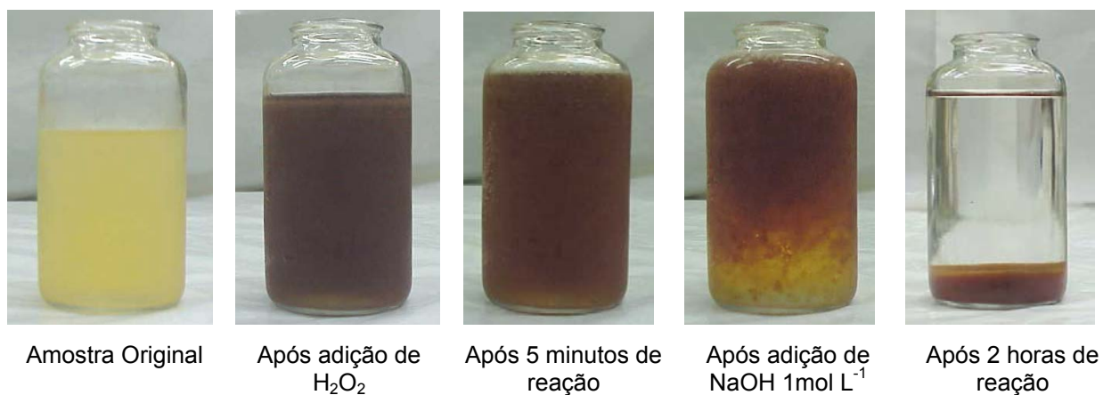
Figura 6.1: Detalhe do comportamento da amostra frente ao \text{H}_2\text{O}_2
