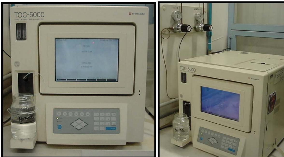
**Figura 1.** Analisador de Carbono Orgânico Total (TOC-5000A, Shimadzu).
