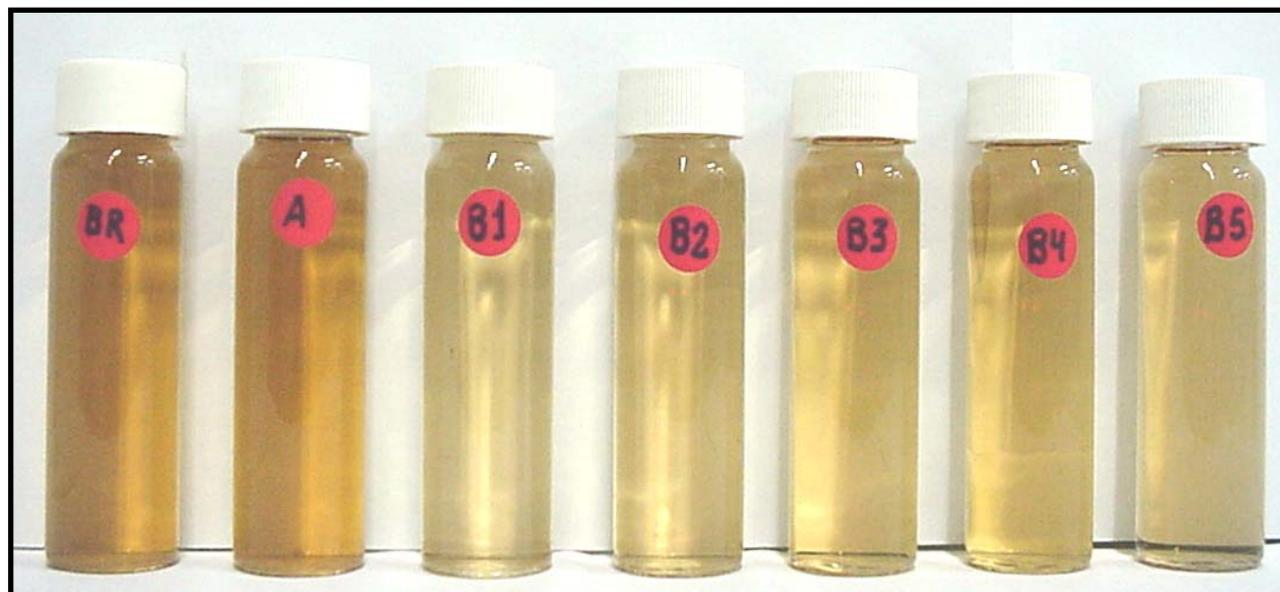
**Figura 34.** Aspecto visual das amostras de efluente de uma indústria têxtil diluídas 50 vezes, após 60 minutos de reação, usando  $900 \text{ mg L}^{-1}$  de  $H_2O_2$  e diferentes relações Fentox<sup>®</sup>: $H_2O_2$ .
