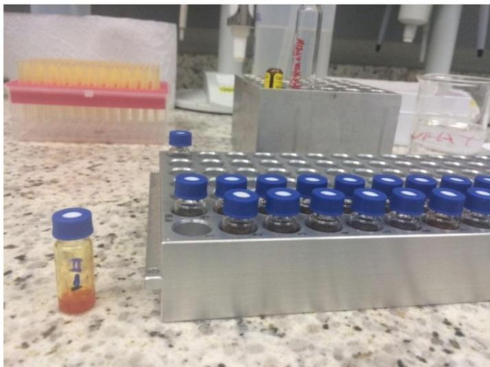
**Figura 22.** Amostras de óleo de urucum em vial após a derivatização com BSTFA.
