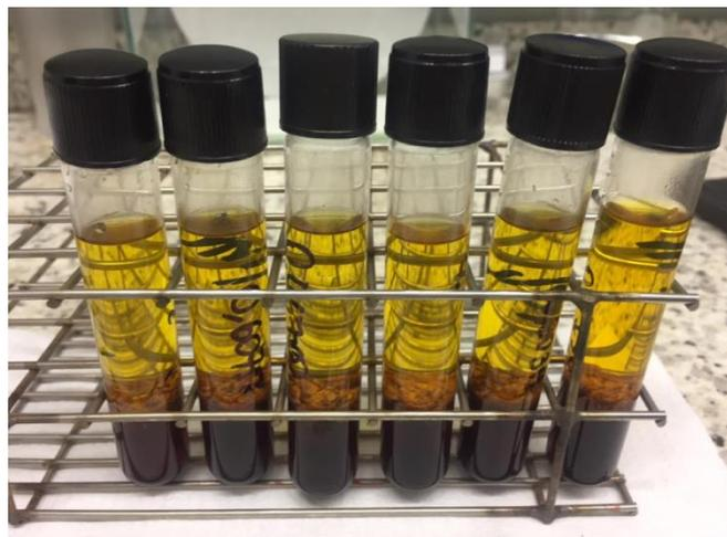
**Figura 21.** Amostras submetidas a extração de Bligh & Dyer. O sobrenadante foi descartado enquanto o líquido mais escuro (camada inferior) foi evaporado sob  $N_2$  para obter o óleo da semente de urucum.
