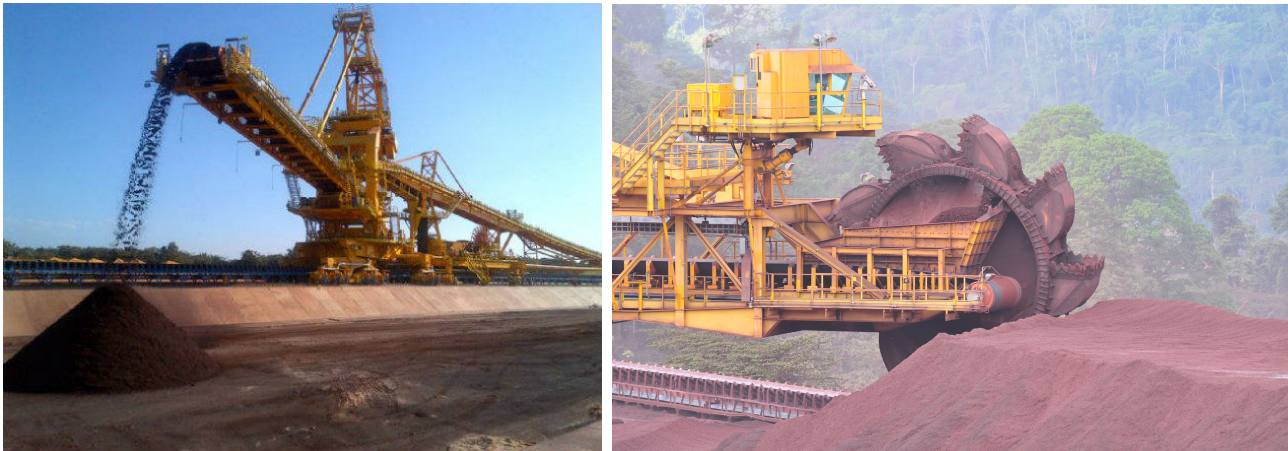
Figura 3.9: Empilhadeira e Recuperadora
