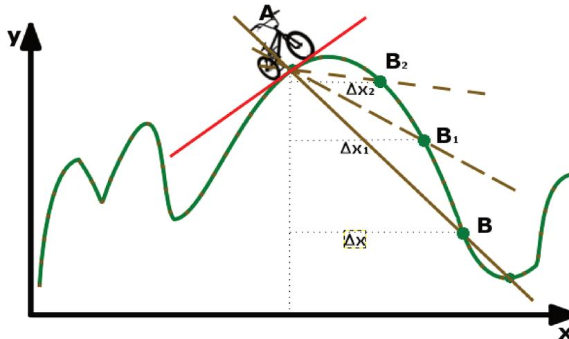
Figura 10 – Fazendo a secante tender a tangente no ponto A ( $\Delta X \rightarrow 0$ )
