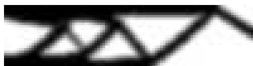
Figura 6.13: Viga em balanço do Exemplo 1 sujeita a grandes deslocamentos, com o filtro de Heaviside, obtida através da PLPS e da PLS, para F = 300000 N .
