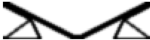
Figura 6.24: Placa do Exemplo 3 sujeita a pequenos deslocamentos com o filtro das densidades ponderadas, para os três métodos.
