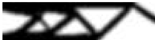
Figura 6.12: Viga em balanço do Exemplo 1 sujeita a grandes deslocamentos, com o filtro das densidades ponderadas, obtida através da PLS, para F = 300000 N .
