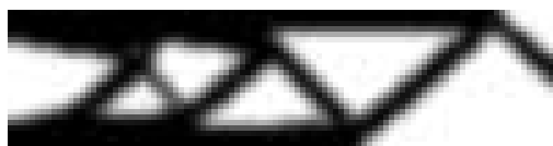
Figura 6.18: Viga em balanço do Exemplo 1 sujeita a grandes deslocamentos, com o filtro das densidades ponderadas, para F = 240000 N .
