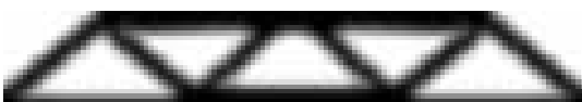
Figura 6.34: Viga MBB do Exemplo 5 sujeita a pequenos deslocamentos, com o filtro de Heaviside, para os três métodos.
