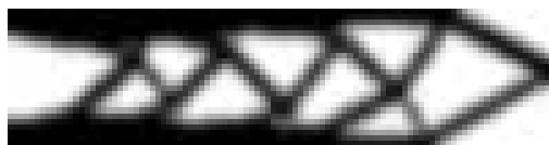
Figura 6.17: Viga em balanço do Exemplo 1 sujeita a grandes deslocamentos, com o filtro das densidades ponderadas, para F = 144000 N .
