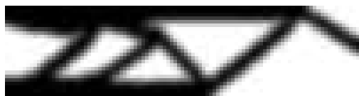
Figura 6.14: Viga em balanço do Exemplo 1 sujeita a grandes deslocamentos, com o filtro de Heaviside, obtida através da PQS diagonal, para F = 300000 N .
