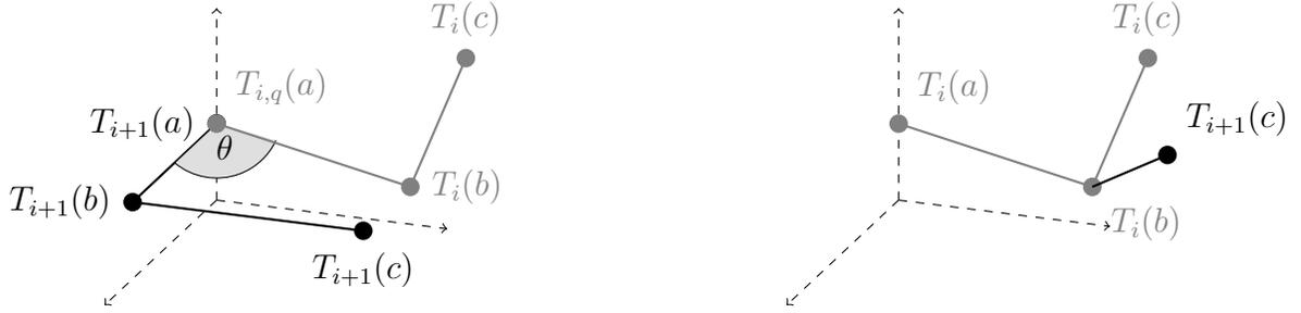
Figura 4.25: Segunda transformação na realização deslizante  $T_{i+1}$ : uma rotação plana em termos do ângulo  $\theta$  e em torno do eixo gerado pelo vetor  $\mathbf{n}$ .
