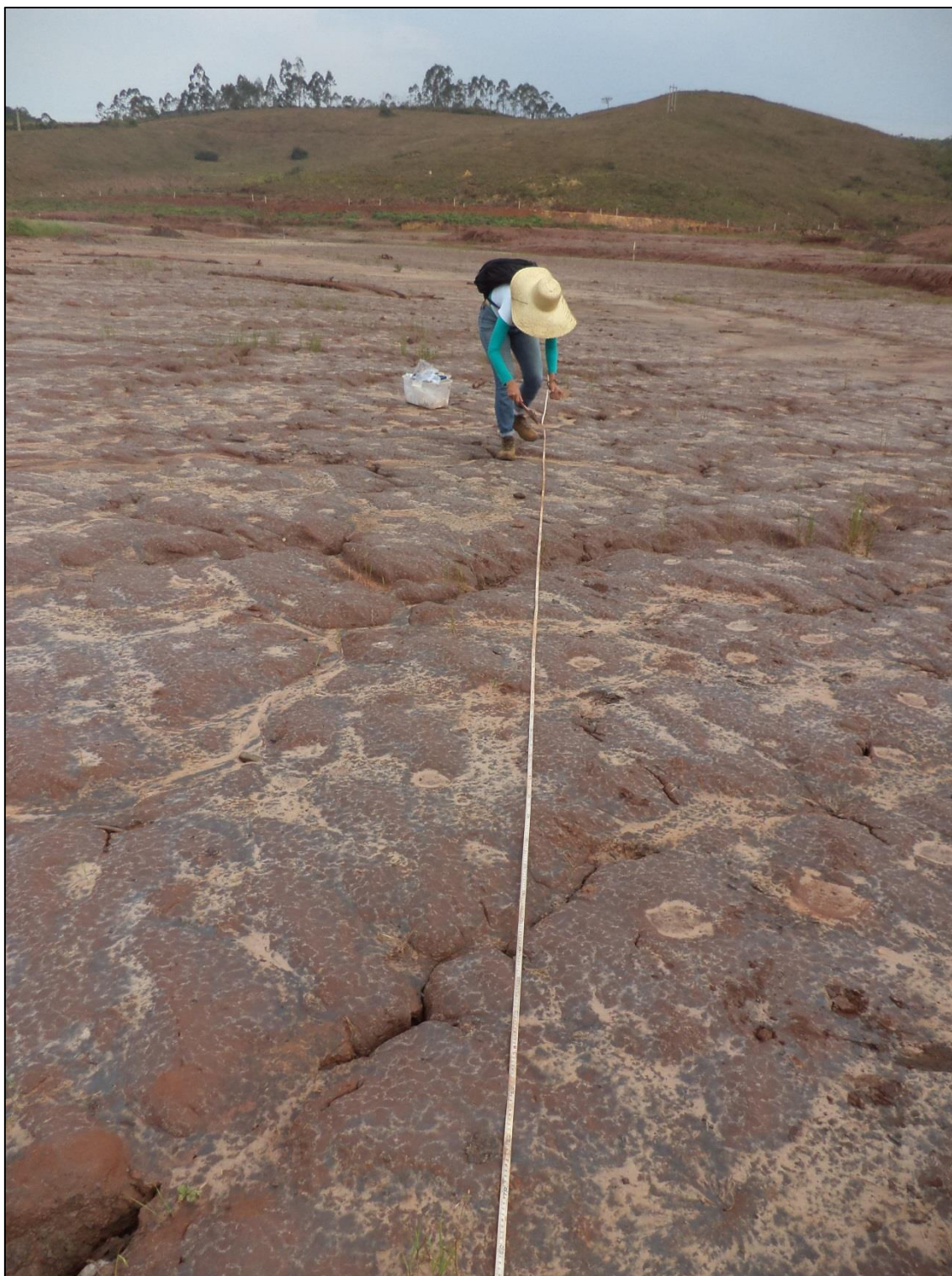
Fig. 5. Foto obtida em 19 de setembro de 2016. Solo encoberto pelo rejeito, bastante compactado e exibindo processos erosivos iniciais. Fonte: Acervo pessoal.
