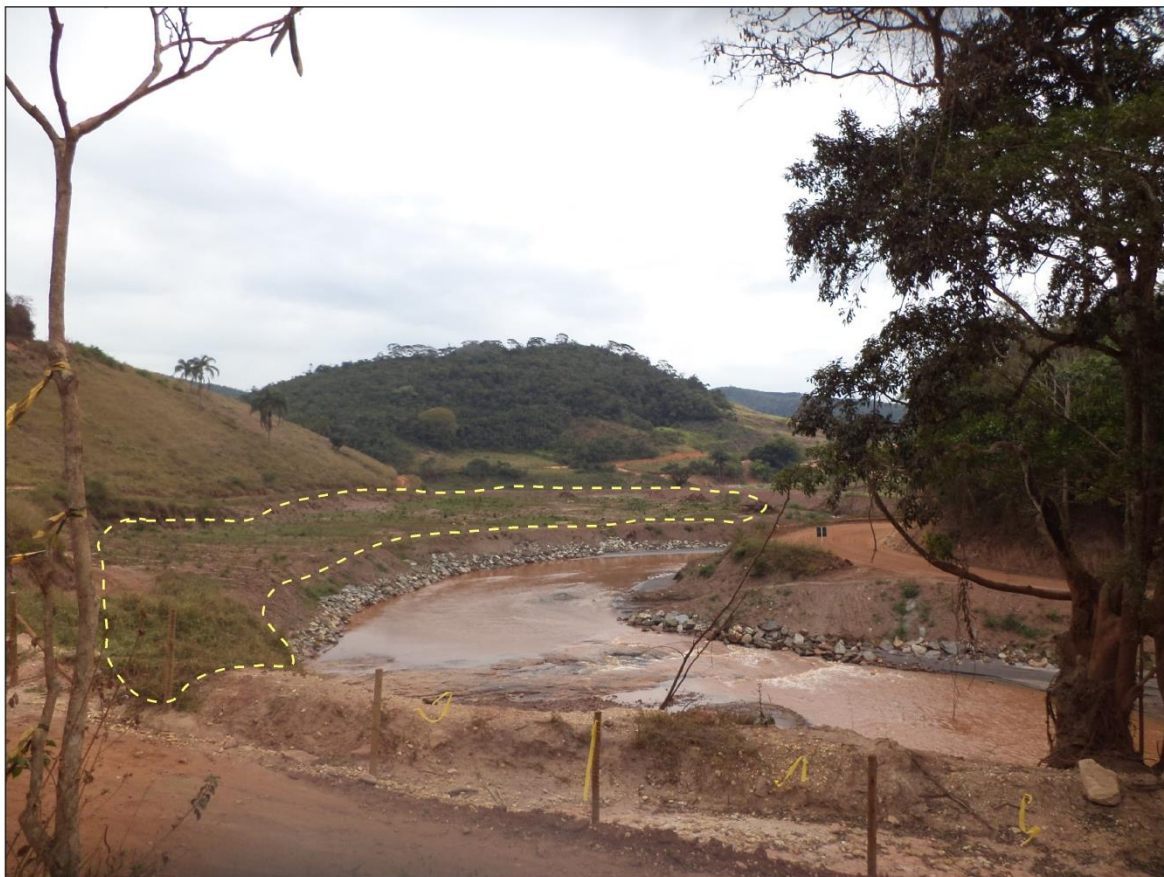
Fig. 6. Foto obtida em 16 de setembro de 2016. Planície de inundação do rio Gualaxo do Norte. Nesse local foi plantado uma mistura de leguminosas as margens do rio para a reparação do solo, destacado com a linha tracejada. Fonte: Acervo pessoal.
