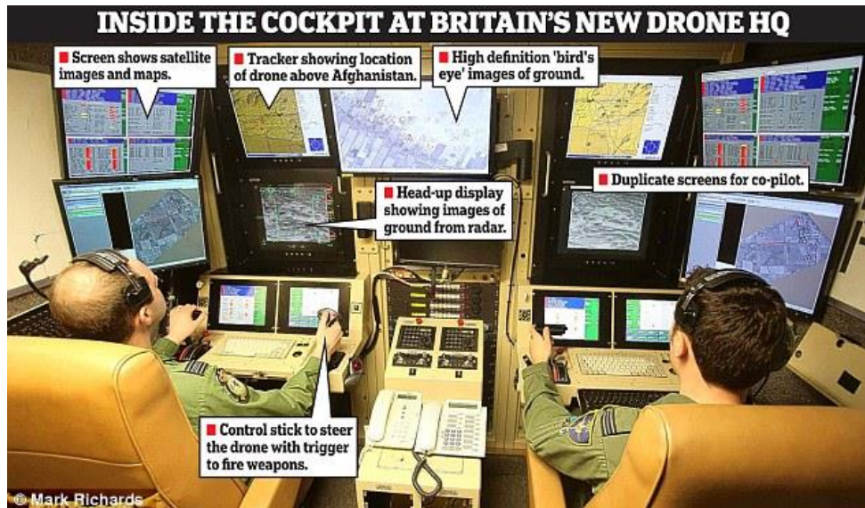
Imagem 13: O interior da estação de controle terrestre de operação dos VANTs britânicos
