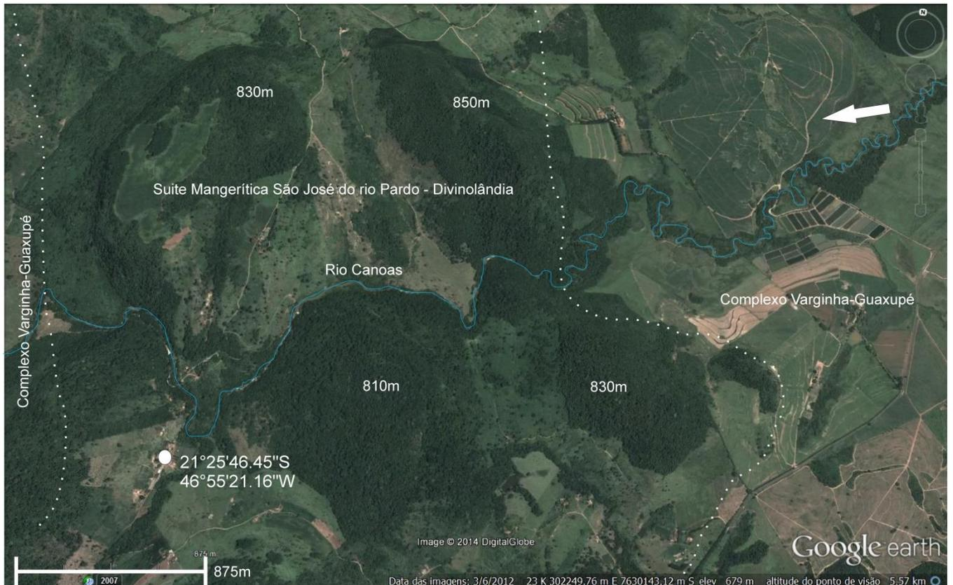
Figura 11: Trecho do rio Canoas com controle estrutural. Ao lado direito da imagem o canal é meândrico, enquanto ao lado esquerdo o canal é retilíneo (a seta branca indica a direção do fluxo da drenagem e os números correspondem às cotas dos altos estruturais).
