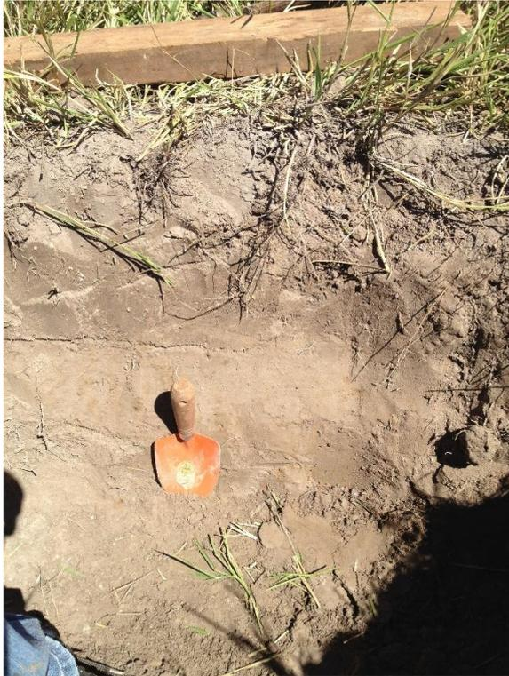
**Figura 7.76** – Trincheira sendo aberta em material arenoso – ponto Santo Anastácio 1
