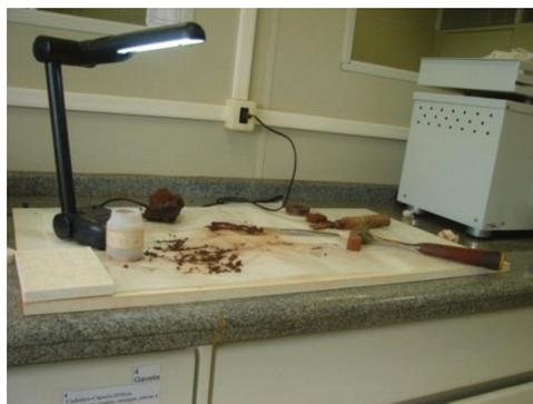
Figura 3.4 – quebra da amostra e separação prévia dos minerais.
