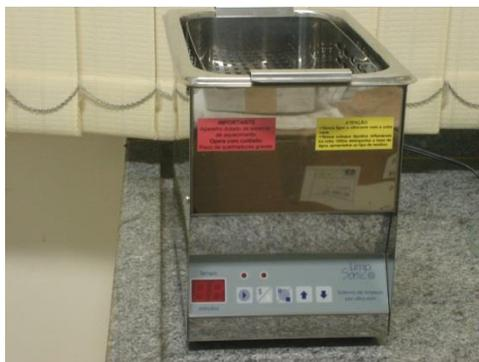
Figura 3.5 – Aparelho ultrassônico utilizado para a lavagem dos minerais.
