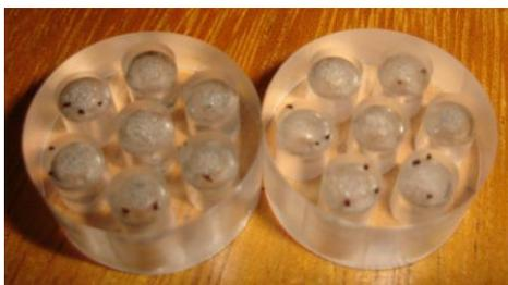
Figura 3.7 – composição de minerais em discos de acrílico para o MEV
