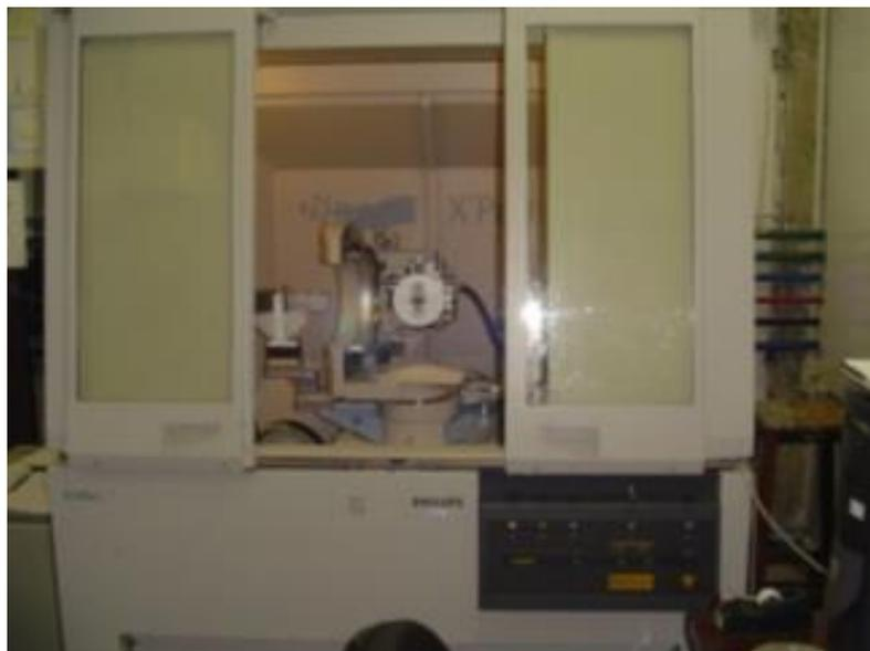
**Figura 3.4.2-**Sistema X'Pert MRD da Philips instalado no LPCM para análises de amostras policristalinas, filmes finos e estrutura epitaxiais semicondutoras.
