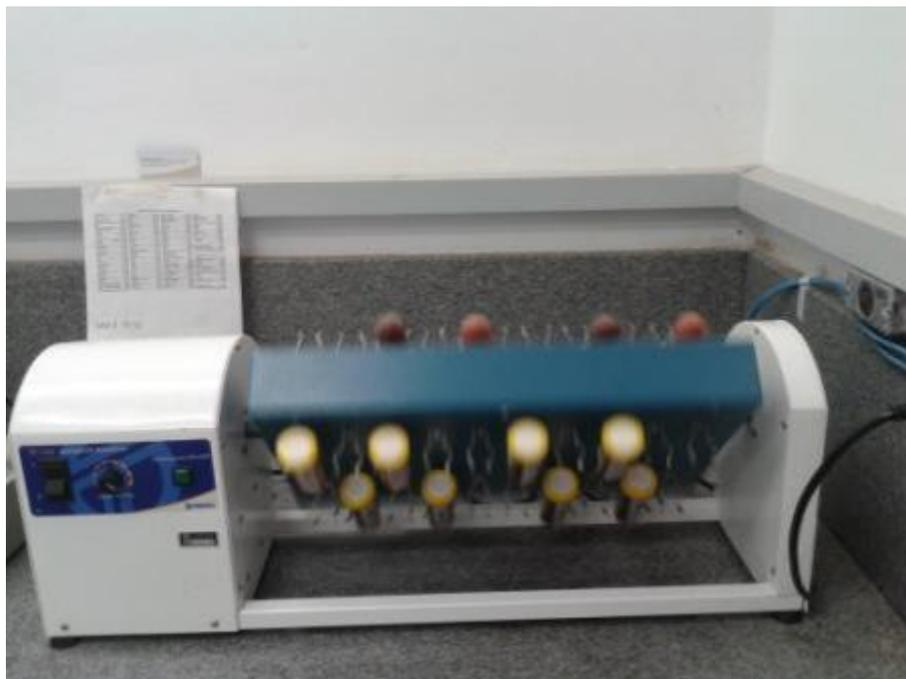
**Figura. 3.2.2-**Centrífuga, agitando as amostras preparadas em solução de Água Deionizada com Hexametáfosfato De Sódio,  $(\text{NaPO}_3)_n$ .
