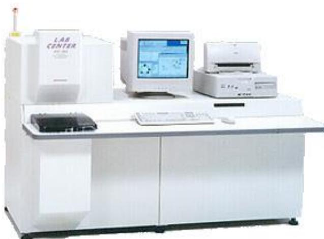
**Figura 3.5.1**-Sistema Espectrômetro Sequencial de Fluorescência de Raios X, WDXRF (PW 2404 - PanAnalytical, Holanda), Laboratório de Geoquímica Analítica, Unicamp.
