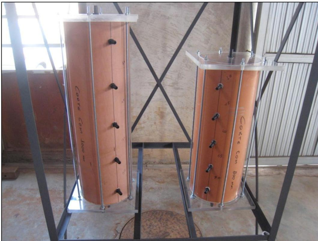
Figura 4.1 - Vista frontal dos permeômetros durante o processo de montagem.
