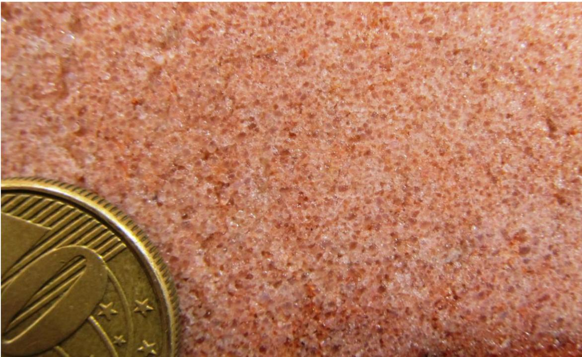
**Figura 17. Seção polida em amostra de quartzo arenito da litofácies “arenito com estratificações cruzadas de alto ângulo”. Observe que é um arenito de grãos bem arredondados, muito bem selecionados, de granulometria que varia de fina a média.**
