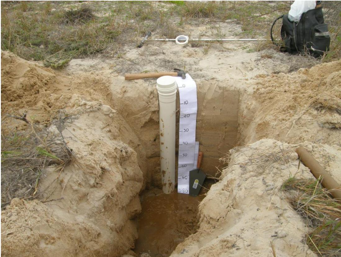
Foto 3.2 - Coleta de Amostra de Sedimentos não deformados
