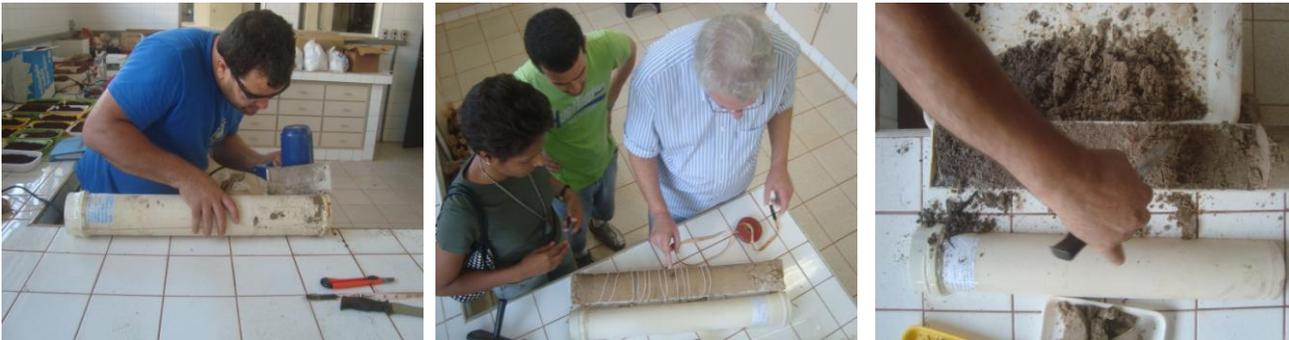
Foto 3.5 - Procedimentos de abertura dos canos de PVC para análise de amostras
