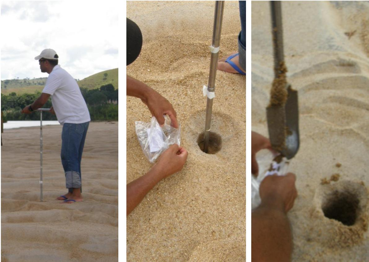
Foto 3.4 - Procedimentos de Coleta com o Trado a Jusante da barragem de Itapebi.
