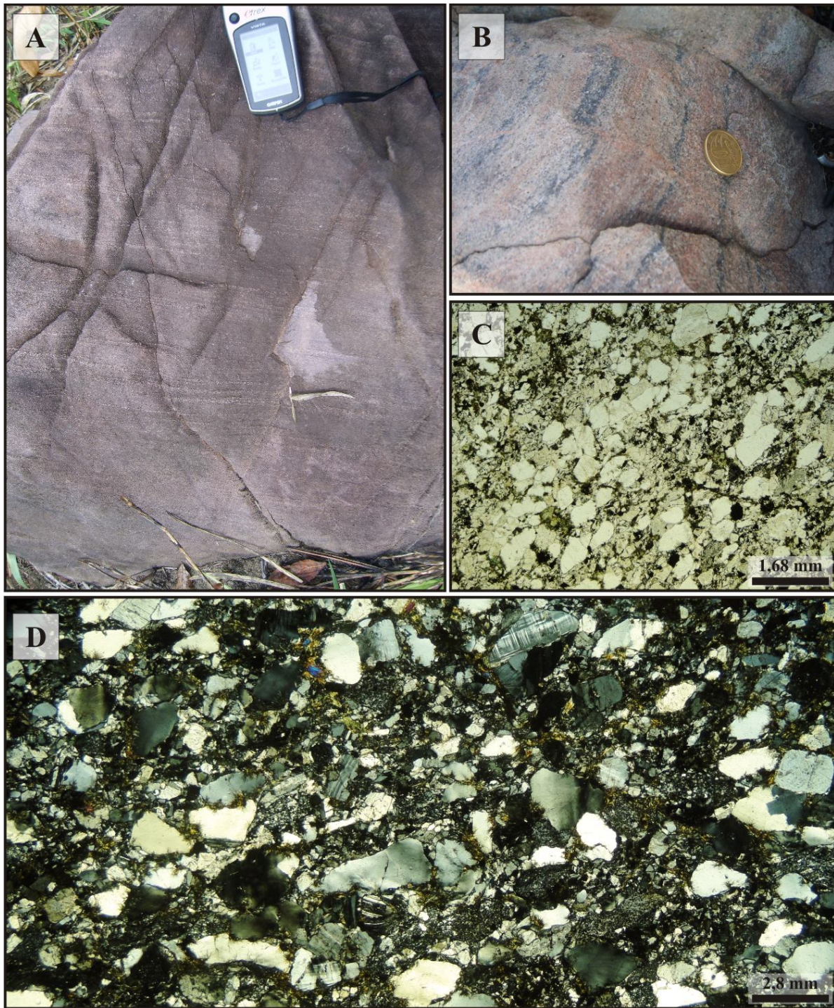
Fig. 9.7. Características macrocópicas e petrográficas do arenito arcoseano lítico vulcanoclástico: (A) Laminação plano-paralela realçada pela iso-orientação dos grãos de quartzo; (B) Lâminas de magnetita + hematita de até 2,5 cm de espessura; (C) Granulometria fina a média, estrutura laminada e cristais angulosos a sub-arredondados; (D) Laminação conferida predominantemente pela iso-orientação dos cristais de quartzo. FOTOMICROGRAFIAS: C: luz natural; D: polarizadores cruzados.
