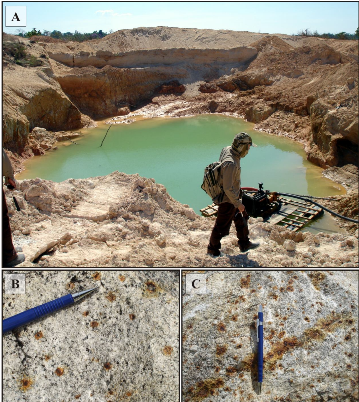
Fig. 6.1. (A) Cava de minério de um dos prospectos da área do Depósito Pé Quente; (B) Monzonito da Suíte Pé Quente com forte alteração sódica pervasiva responsável por sua tonalidade branco-leitosa; O minério é dominado por pirita grossa e ocorre tanto disseminado em zonas de alteração sódica pervasiva quanto (C) confinado a veios de quartzo + albita.
