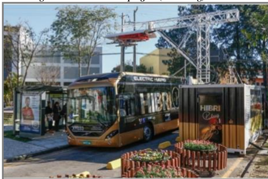
Figura 4.11 Bus híbrido plug-in (HibriPlug) de Volvo
