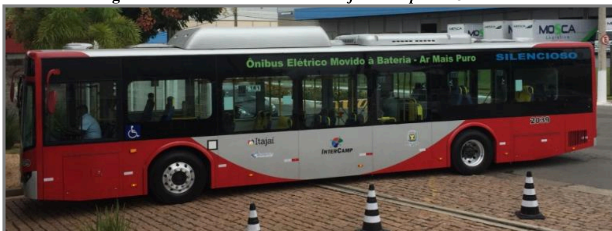
Figura 4.9 Bus eléctrico a batería Itajaí Transportes Coletivos
