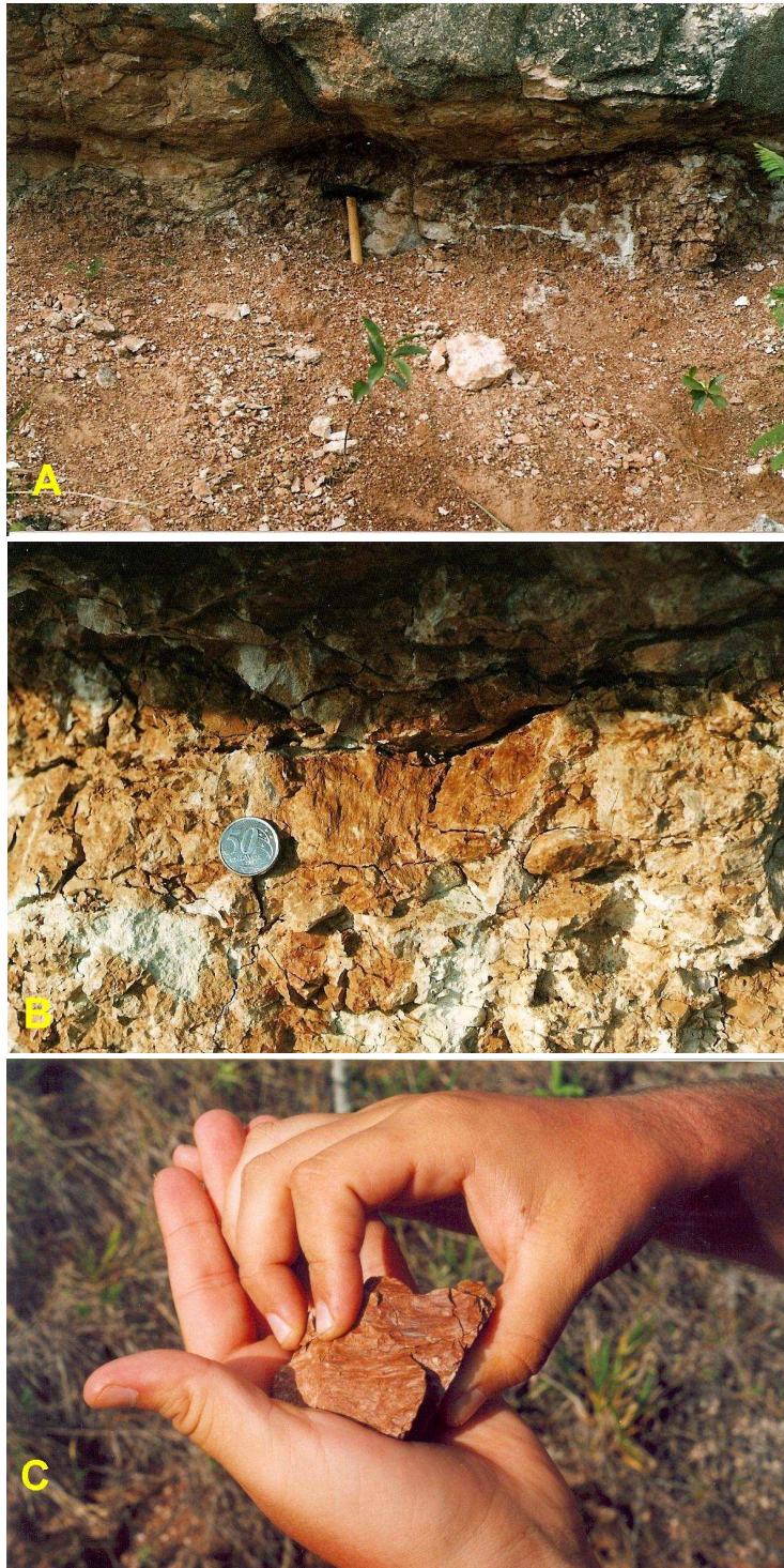
Figura 10.7 – A: Perfil 5 com vertissolo na base no afloramento; B e C: planos de slickensides resultantes do movimento expansivo das argilas.
