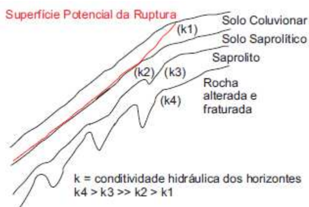
Figura 9.3 - Linha de contato do solo coluvionar com o solo saprolítico
