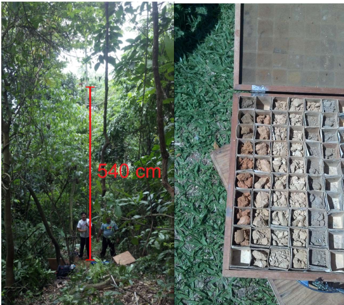
Figuras 5.1. e 5.2 - Tradagem 5 da Toposequência 2, com suas respectivas 54 amostras armazenadas no pedocomparador para análise
