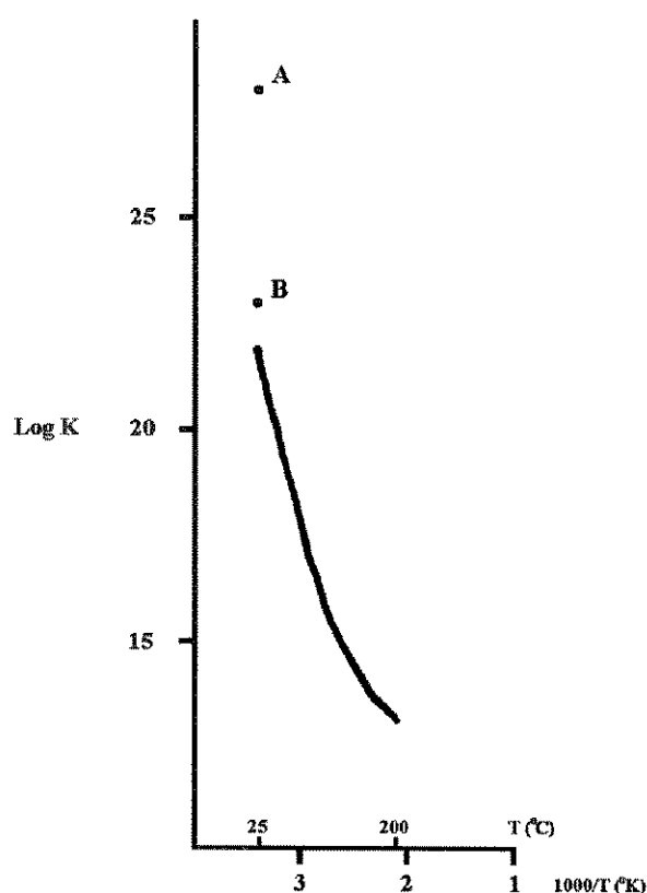
Figura 3.13: Log K x 1/T para dissolução de Pd como \text{PdCl}_4^{2-} calculado por Mountain & Wood (1988). Ponto A refere-se à reação 2\text{Au} + 6\text{H}^+ + 3/2\text{O}_2 + 8\text{Cl}^- = 2\text{AuCl}_4^- + 3\text{H}_2\text{O} , enquanto o ponto B representa a reação 2\text{Au} + 12\text{H}^+ + 3\text{MnO}_2 + 8\text{Cl}^- = 3\text{Mn}^{2+} + 2\text{AuCl}_4^- + 6\text{H}_2\text{O} , ambas as constantes de equilíbrio calculadas a 25°C a partir de dados contidos em Krauskopf (1951).
