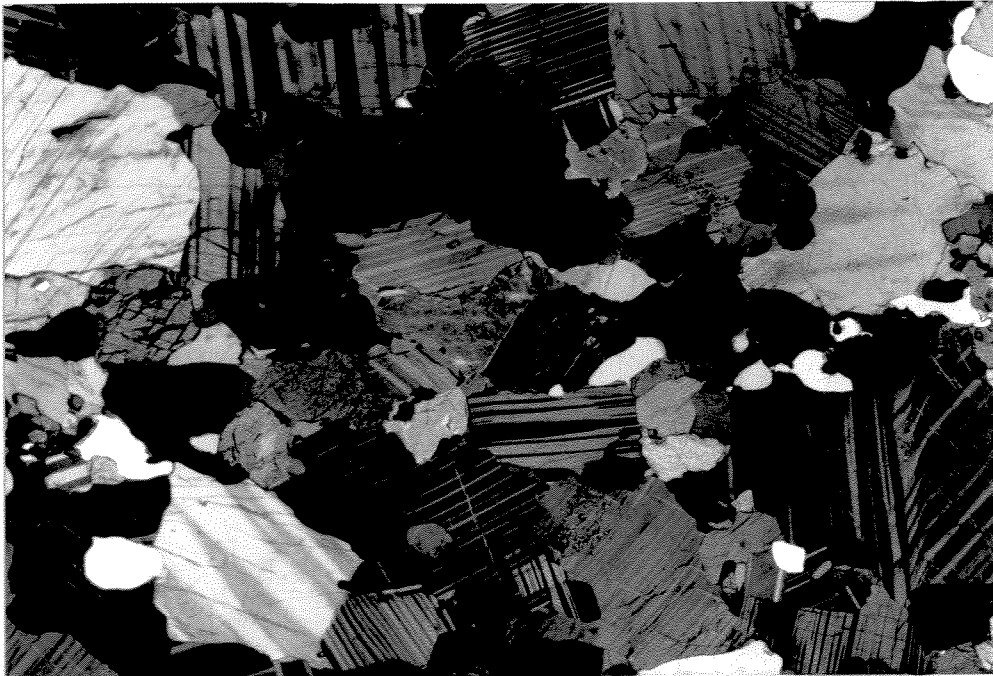
Figura 3.14 - Fotomicrografia de lâmina delgada dos granulitos enderbíticos do Domínio Leste apresentando sua mineralogia principal e textura granoblástica (aumento de 32x).
