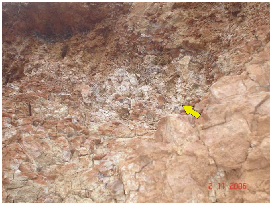
Figura 6.6: Seta indicando um perfil com blocos definidos como slickensides .
