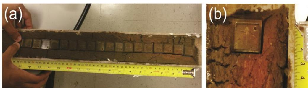
**Figura 8:** (a) Processo de coleta de amostra. Tubo de PVC cortado longitudinalmente e amostragem com as caixas de acrílico. (b) Caixa de acrílico de 2 cm de lado utilizadas para amostragem, referentes ao testemunho XC01-02.
