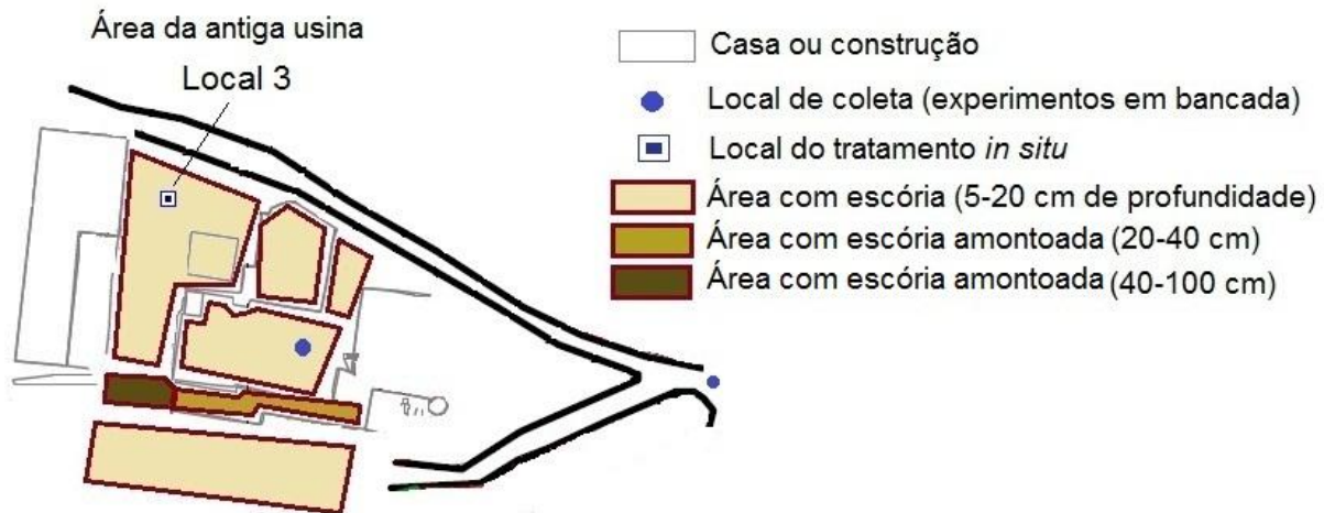
Figura 4.4: Mapa da área da antiga usina localizada no CIEM/CPRM – Apiaí (SP), com a localização das concentrações de escória
