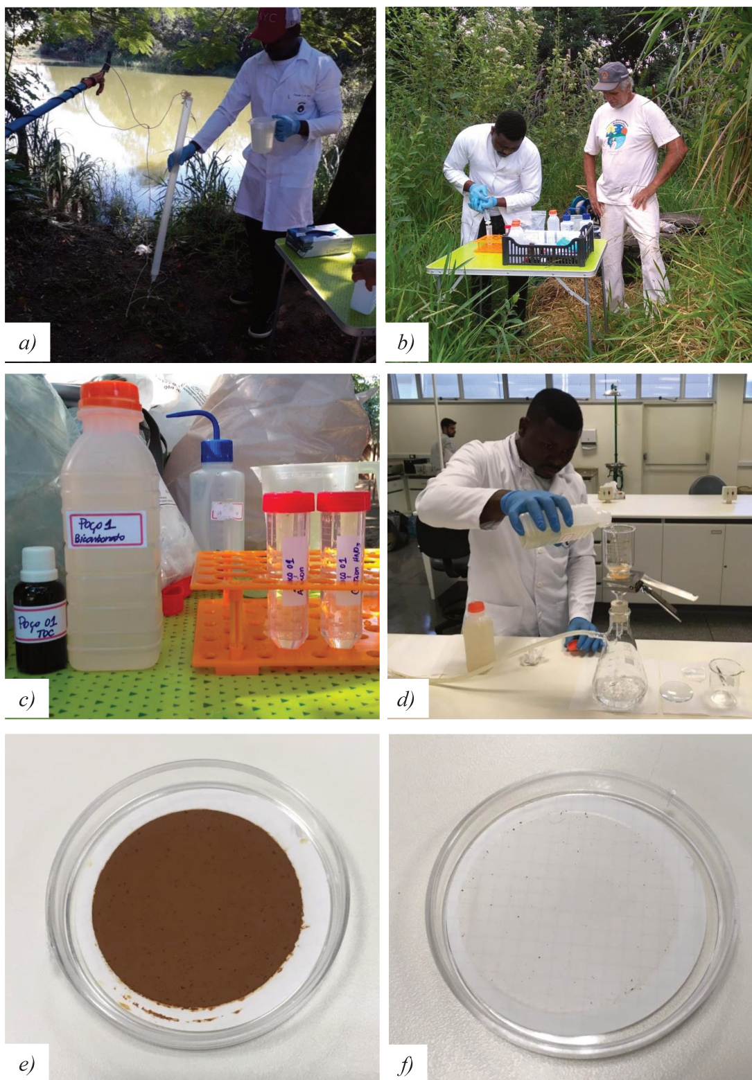
Figura 4.4: Procedimentos de amostragem e filtração; a) Coleta de amostra; b) filtração em campo; c) frascos usados para condicionamento das amostras; d) filtração à vácuo de amostras de cafeína no laboratório, e) e f) papel de filtro com particulados >0,22\ \mu\text{m} .
