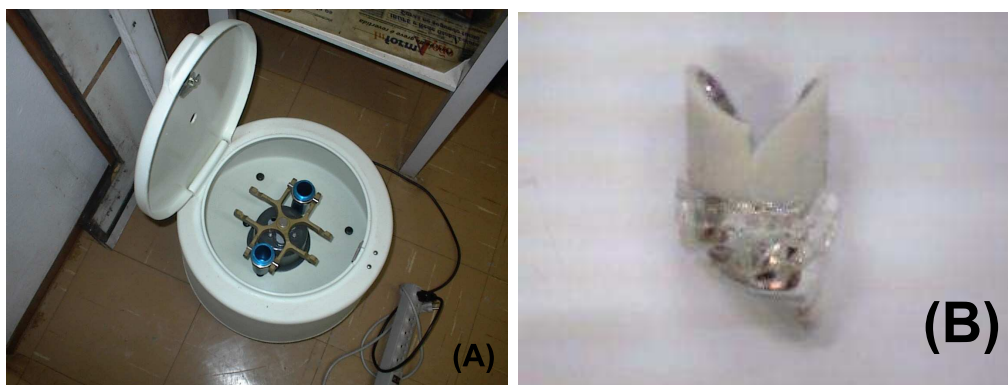
Figura 4.3: (A) Centrífuga utilizada na extração mecânica do fluxo. (B) Cadinho após remoção do fluxo.
