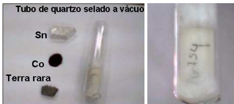
Figura 4.1: Montagem das amostras e detalhe do tubo de quartzo.
