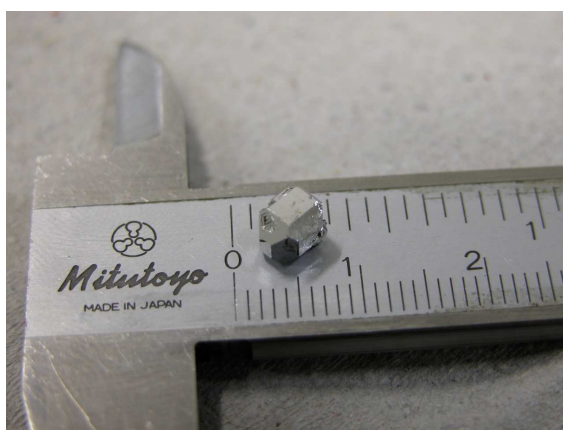
Figura 4.4: Cristal típico da família 3-4-13, ilustrado na foto por um cristal de \text{Eu}_3\text{Ir}_4\text{Sn}_{13} , obtido via técnica de fluxo metálico.
