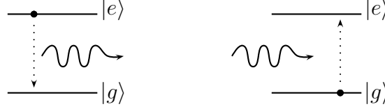
Figura 1.2: Esquema da interação descrita pelo modelo de JC. Criação de um fóton pelo decaimento do átomo (esquerda) e absorção de um fóton pelo átomo que passa a ocupar um estado de maior energia (direita).
