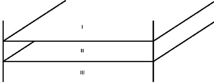
Fig. 2.2: A figura mostra um guia de ondas formado com três camadas.
