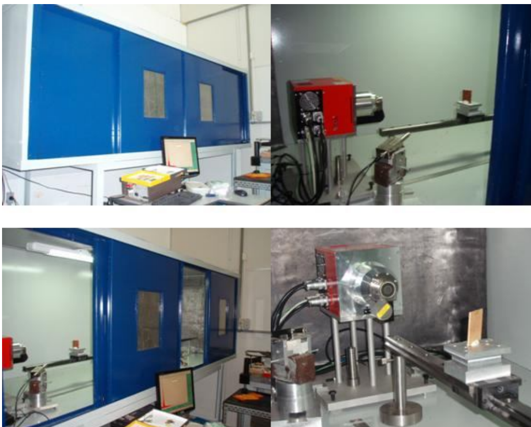
Figura 6.2: Montagem experimental do gerador microfoco na cabana blindada com chumbo no Laboratório de Cristalografia Aplicada e Raios X do IFGW-UNICAMP
