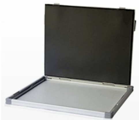
Figura 5.3: Cassete para filme radiográfico. A região branca é a tela intensificadora.
