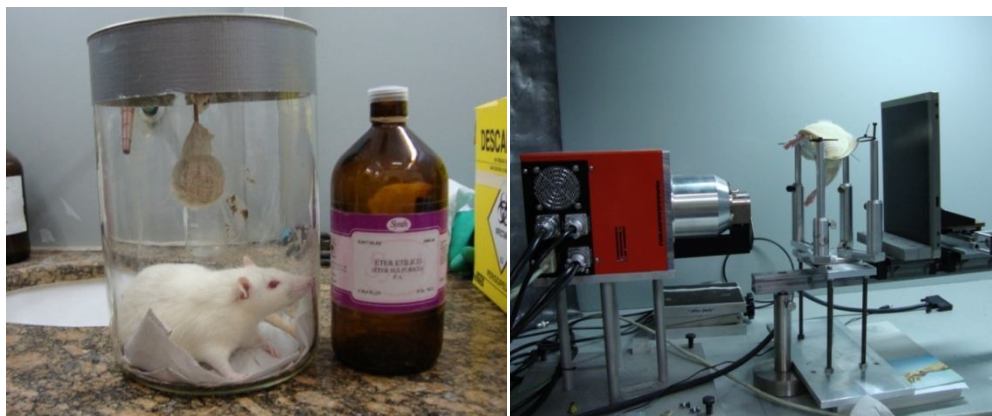
Figura 6.13: A. Foto do animal numa campânula dopada de éter para sedação. B. Foto do animal na estação experimental para ser radiografado
