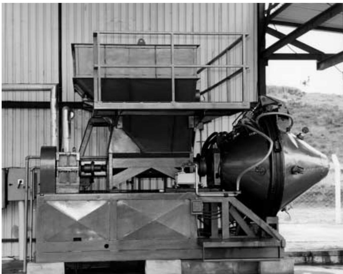
*Figura 5.9 – Reator de Pré-hidrólise Ácida Piloto (300 kg de biomassa/reação).*
