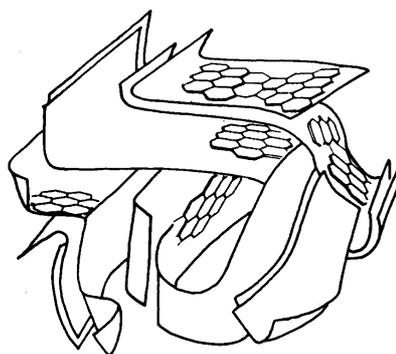
Figura 4.3 – Esquema da estrutura de Carvões Ativados proposto por Stoeckli (1990).
