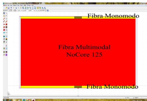
Figura 15. Modelo geométrico da estrutura SMS com MMF no-core de 125 \mu m com BeamProp.
