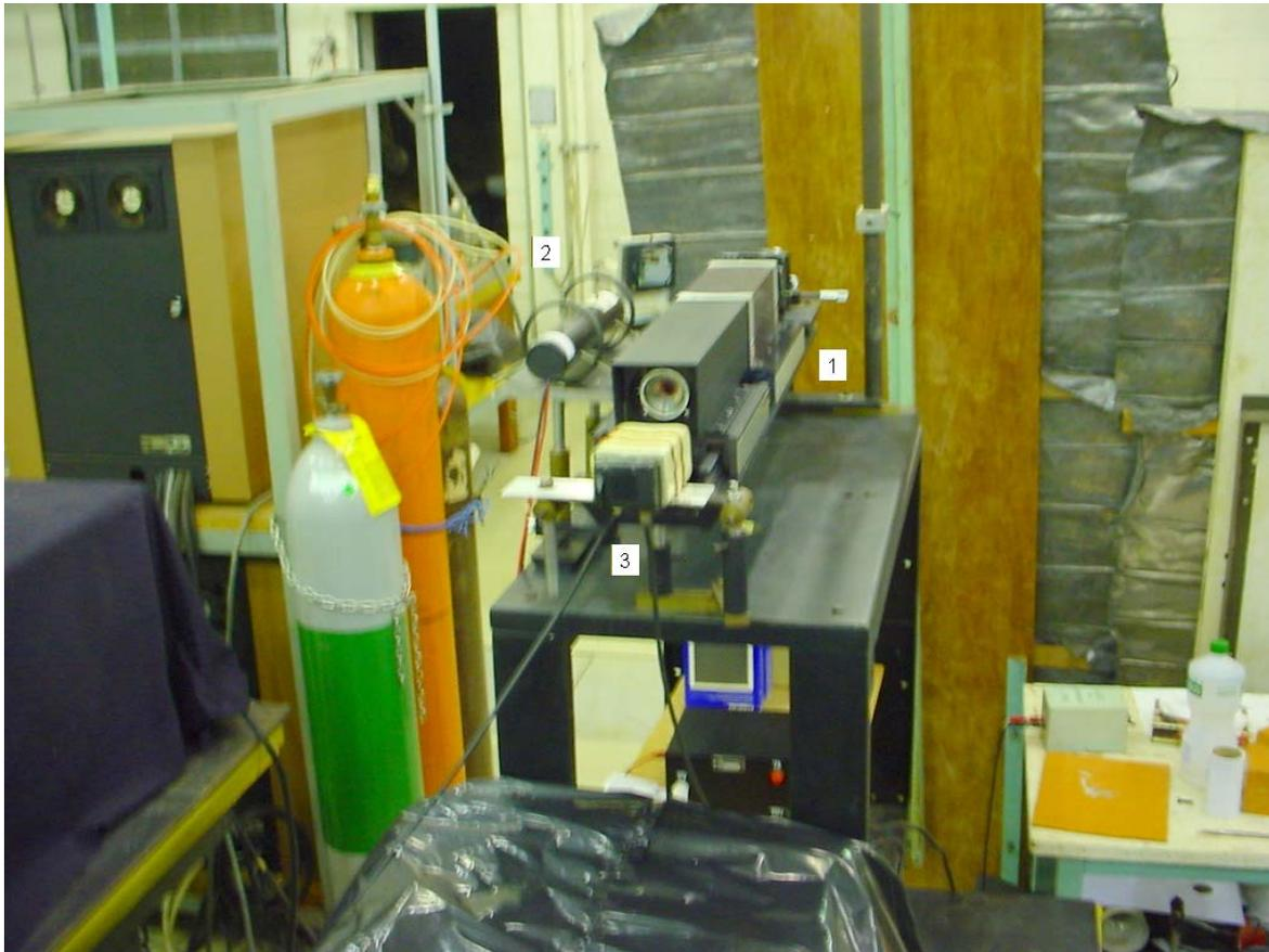
Fig. 5.3: Foto mostrando o laser de rubi (nº 1), o laser de He-Ne 1 (nº 2), e a caixa do fotodiodo (nº 3).
