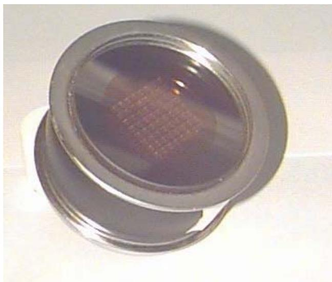
Fig. 5.19: Detector multicanal Philips XP 1752, a matriz de sensores 8 x 8 está distribuída no centro do cilindro.
