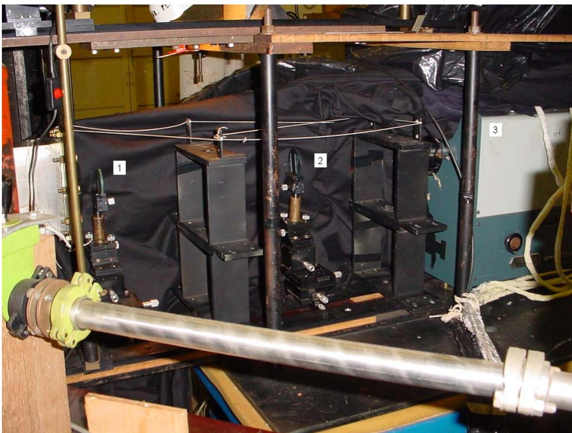
Fig. 5.12: Foto mostrando a lente de coletora (nº 1), a lente de casamento (nº 2), e o espectrômetro SPEX (nº 3).
