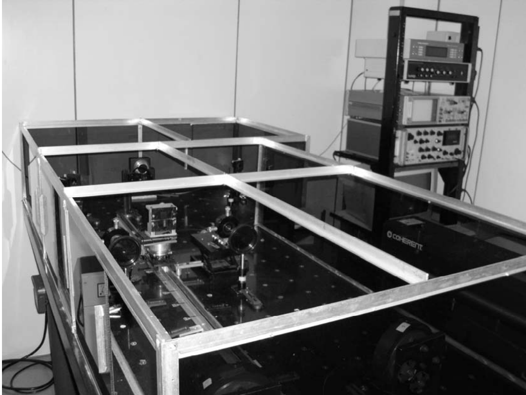
Fig. 3-10. Fotografia da montagem holográfica para UV. As dimensões do interferômetro são 1,2m de largura por 2,5 m de profundidade.
