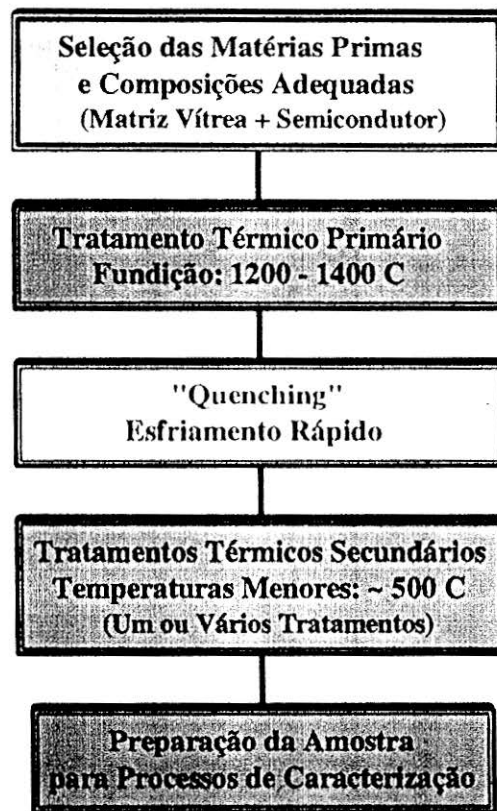
Figura II.1 - Esquema do Processo de Fabricação dos VDS.
