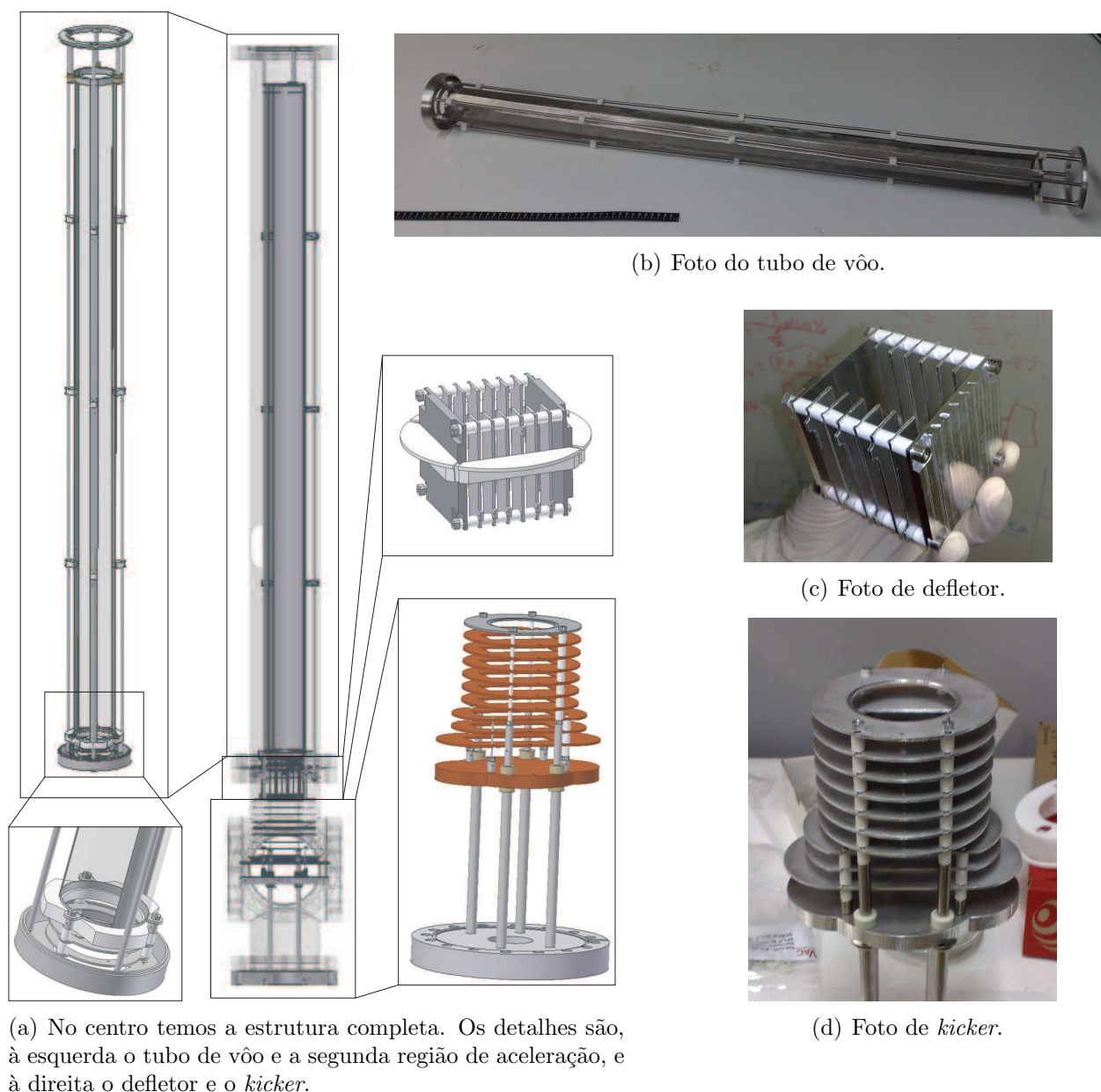
Figura 27: Projeto e fotos do novo espectrômetro de massa por tempo de vôo.
