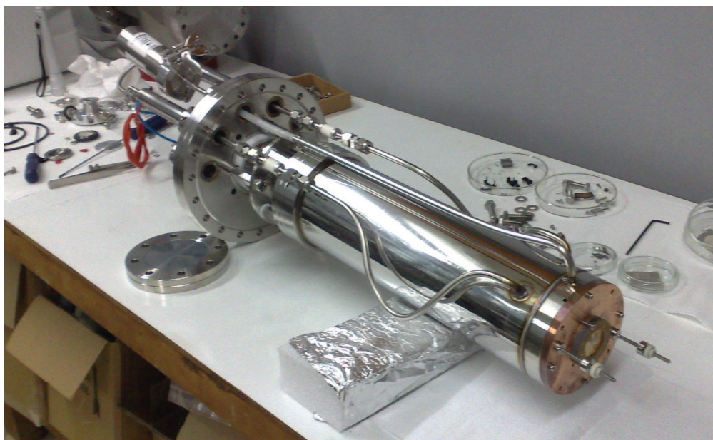
Figura 39: Foto da “camisa” refrigerada.
