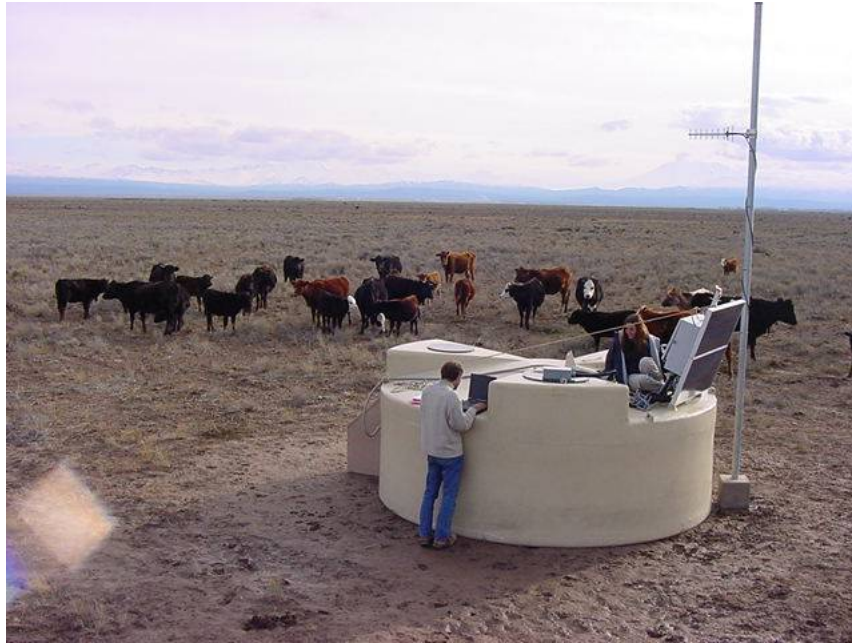
Figura 4.1: Instalação e calibração de um dos tanques Cherenkov no sítio sul do Observatório Pierre Auger.
