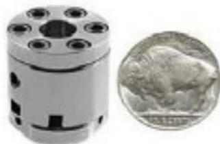
**Figura 4.8.:** Mini célula de diamantes utilizada para experimentos de XMCD na linha 4ID-D do APS.
