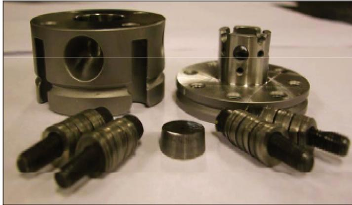
**Figura 4.3.:** Células de pressão de diamante usadas para a realização dos experimentos de XRD no composto de  $\text{EuPt}_2\text{Si}_2$ .
