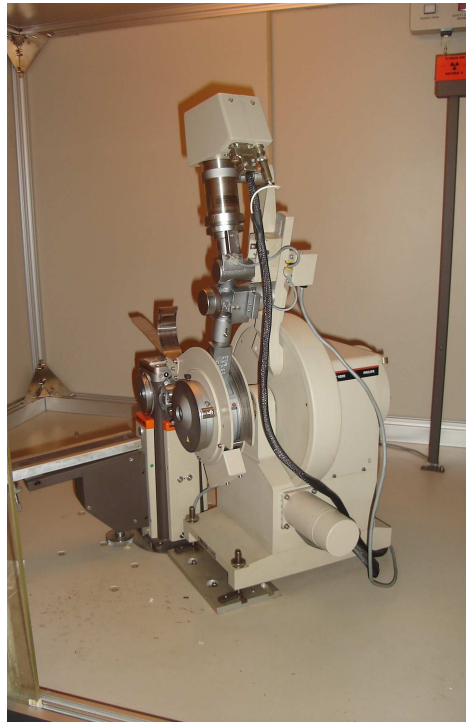
Figura 3.13: O difratômetro de raios-X Philips utilizado neste trabalho.
