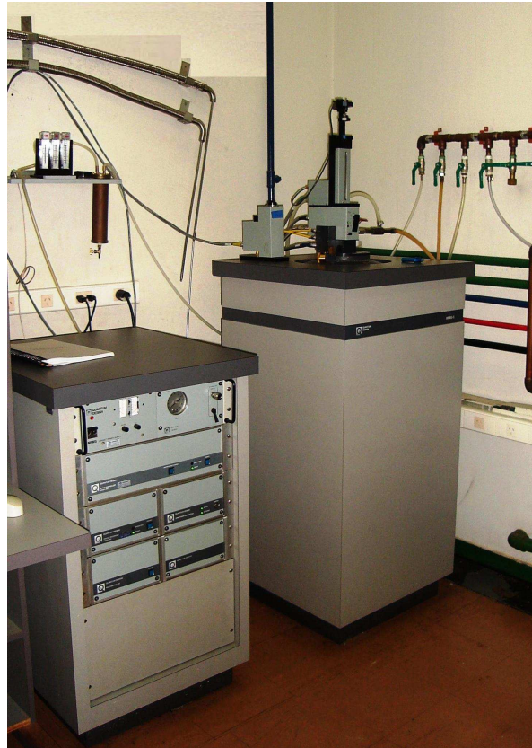
Figura 3.8: O SQUID, modelo MPMS-5, da Quantum Design, utilizado neste trabalho.
