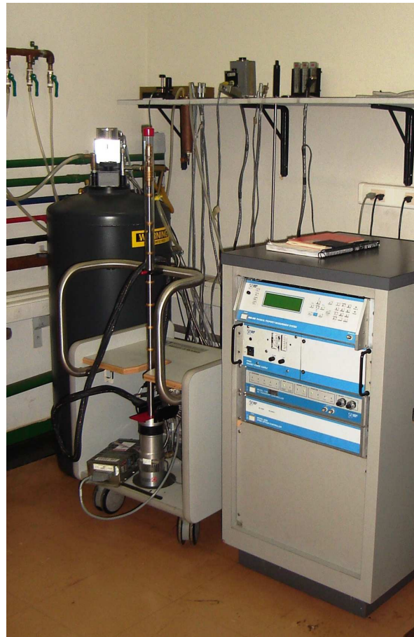
Figura 3.1: O PPMS, modelo PPMS-9 (Quantum Design), utilizado neste trabalho.
