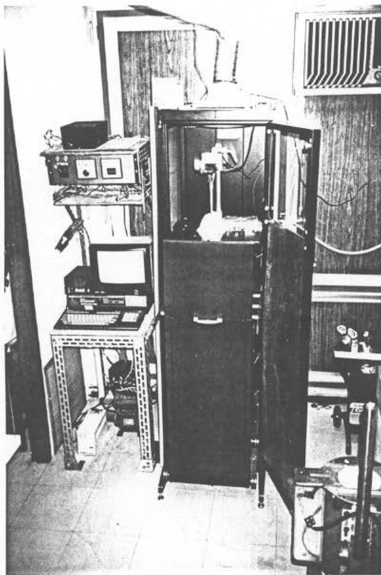
Figura 3.9: Sistema para síntese de **InP** com saída exaustora.
