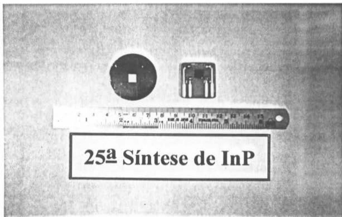
Figura 5.1: Amostra de **InP** soldada ao suporte para caracterização elétrica.
