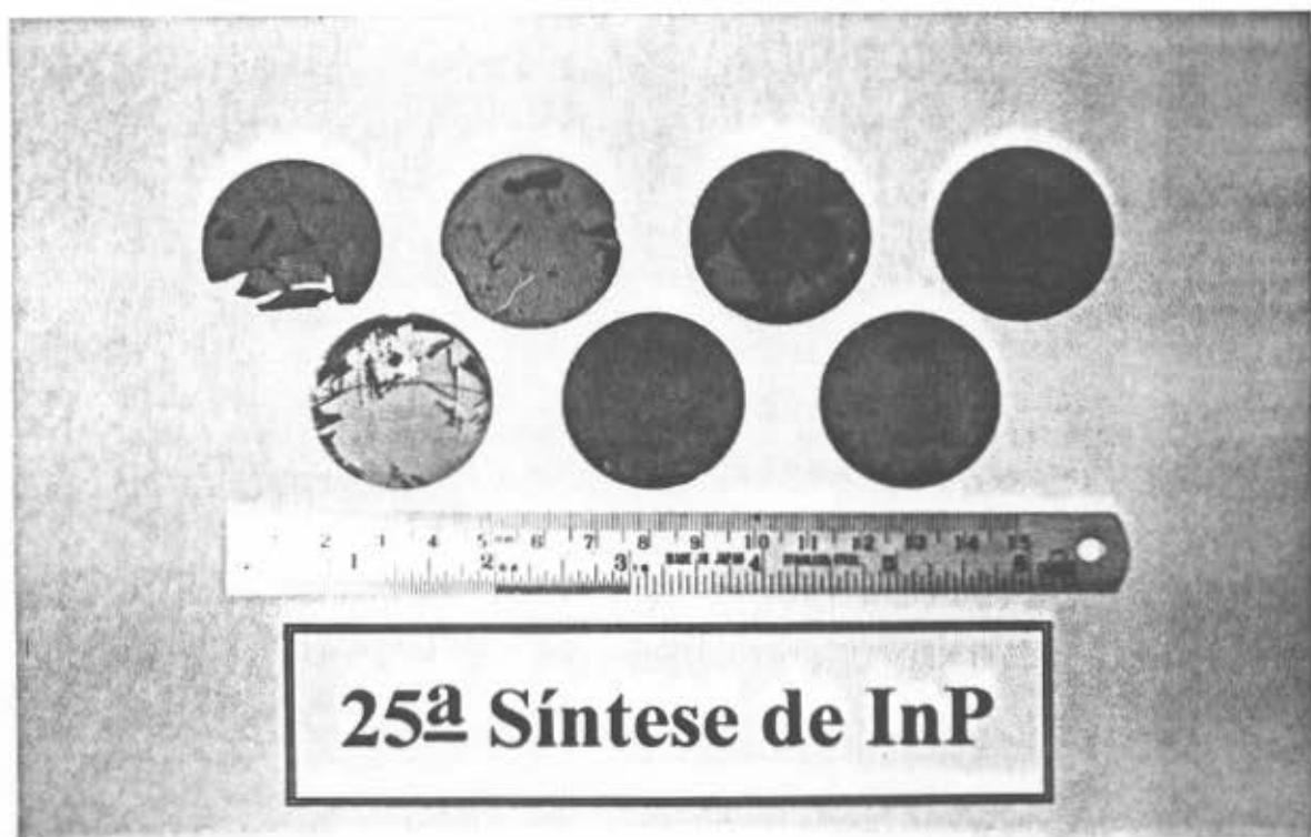
Figura 4.49: Lâminas do 25º tarugo de InP.
