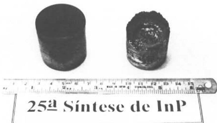
Figura 4.48: Tarugo da 25ª síntese ao lado do cadinho de carbono-vítreo.
