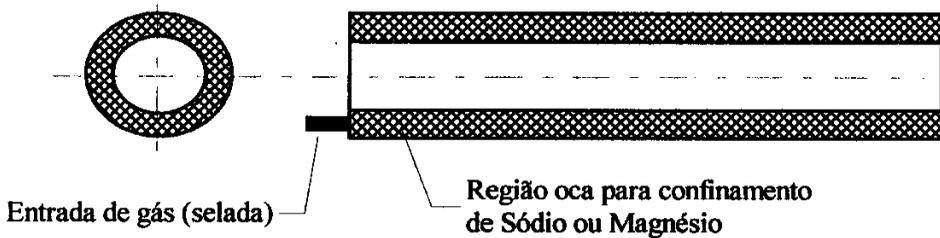
Figura 3.4: Homogenizador de temperatura.
