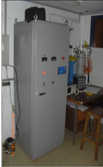
Figura 2-4 Fotografia da fonte pulsada Pulsa 40, Plasma-LIITS.
