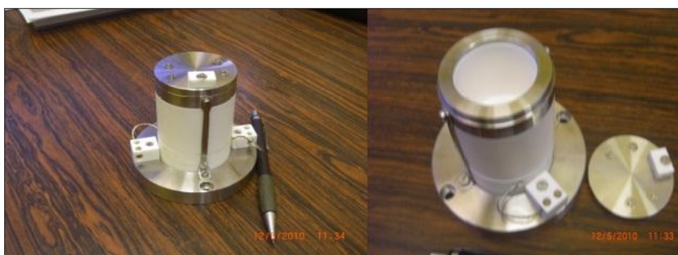
Figura 2-6 Fotografia do porta amostra com aquecedor desenvolvido neste projeto.
