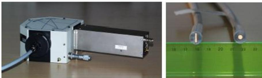
**Figura 5.33:** Esquerda: foto do detector multiespectral. Direita: foto da fibra de acoplamento mostrando a ponta retangular e a outra ponta circular.
