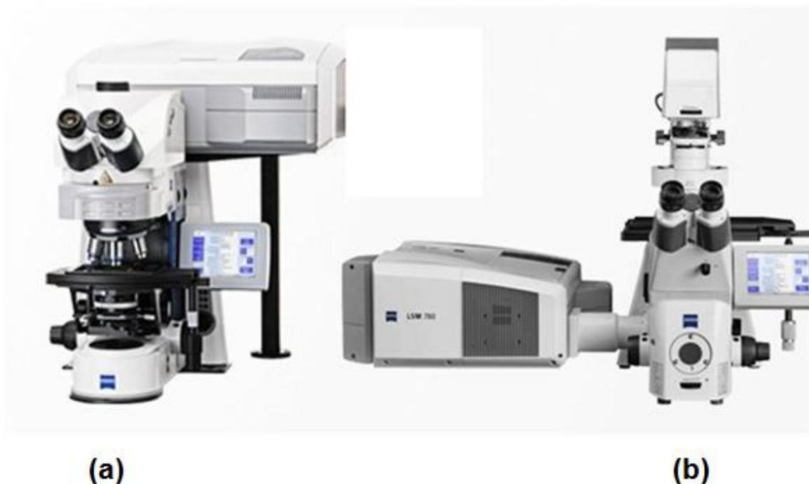
Figura 5.9: microscópios confocais LSM 780 da Zeiss. Esquerda: *upright*. Direita: *inverted*. Fotos obtidas do site da Zeiss<sup>§§§</sup>.
