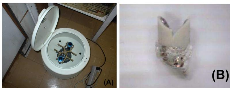
Figura 3.3: (A) Centrífuga utilizada na extração mecânica do fluxo. (B) Cadinho após remoção do fluxo.
