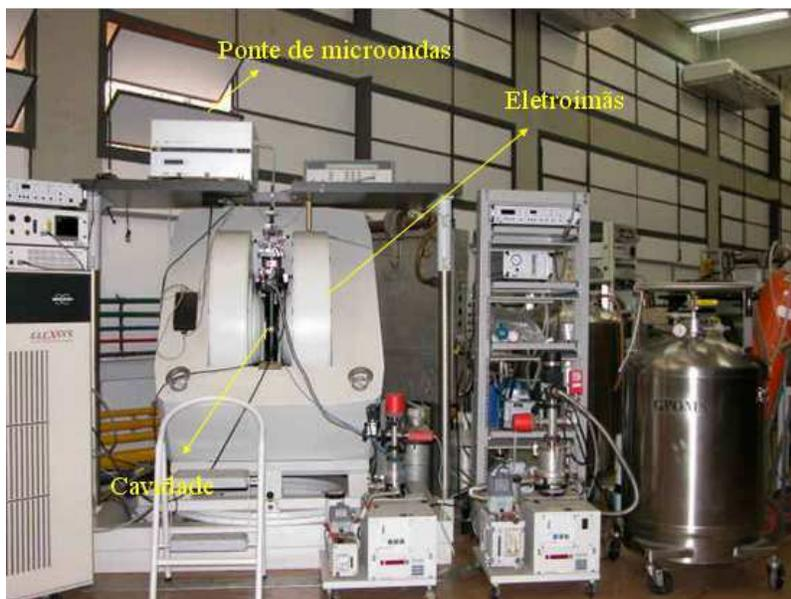
Figura 3.7: Espectrômetro de ESR.
