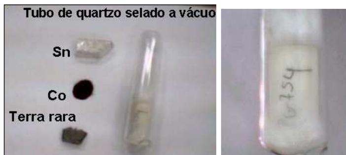
Figura 3.1: Montagem de uma amostra de  $R_3Co_4Sn_{13}$  para crescimento por fluxo metálico e detalhe do tubo de quartzo.
