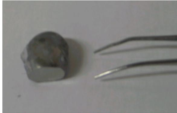
**Figura 4.2** – Botão de uma amostra de La-Fe-Si fundida no forno a arco e cortada transversalmente.
