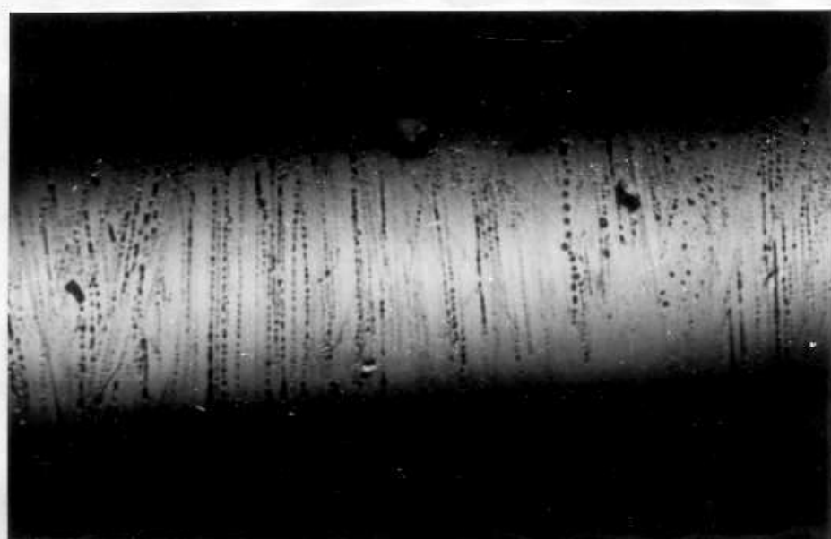
FIG.11 - 4 minutos de polimento - 90X
