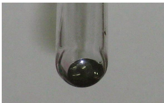
Figura 2.4: NPs de prata no tubo de ensaio após o processo de centrifugação.
