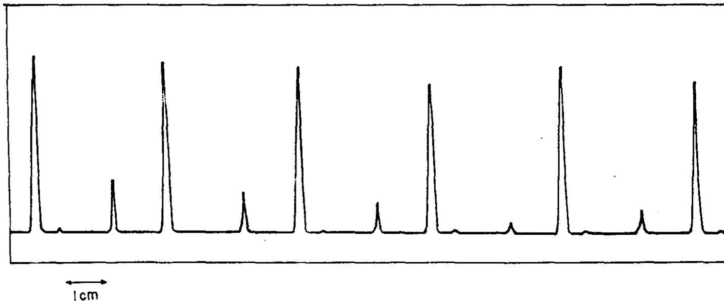
fig. IV-22. Linha de 738,8\mu\text{m} bombeada pela 9R(12). Nesse caso, dois modos da mesma linha oscilam na cavidade, mas a estrutura do espectrograma é bastante simples e o comprimento de onda pode ser determinado sem a menor dúvida.
